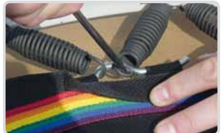
Sollte einmal eine Feder brechen, dann benutzen Sie das Gerät nicht weiter, sondern ersetzen Sie zuerst die defekte Feder / Broken springs must be replaced / Un ressort cassé doit être remplacé.
