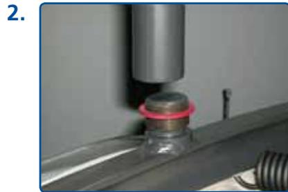
Den Sicherungsring mit ca. 2 Windungen auf den Stutzen drehen\*
